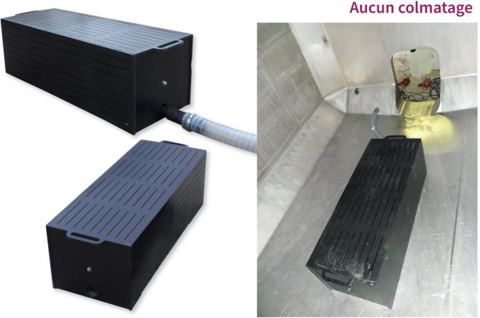
Ni vis, ni fixation, il est autoporteur grâce à ses blocs de béton intégrés et démontable, ce double caisson avec grille d'aspiration intérieure se relie à la vanne de sortie de cuve pour Ø 30-40-50 et plus. Compatible Thermo vinification - Equipé de poignée de portage.
