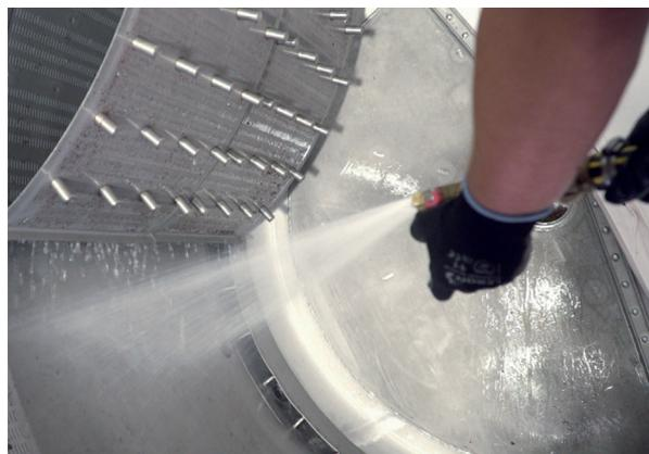
Grilles de drainage Fast Press pivotantes pour le lavage facilité
