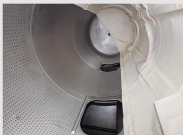
Intérieur d'une cuve poinçonnée avec membrane et spires de recentrage des marcs
