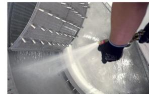
Grille de drainage Fast Press pivotante pour le lavage facilité
