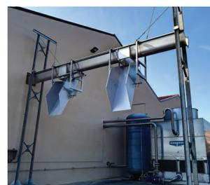
*Évacuation des marcs par vis sans fin avec système de portant et goulotte pour remplissage des poly-bennes - pilotage pneumatique des goulottes et trappes.*
