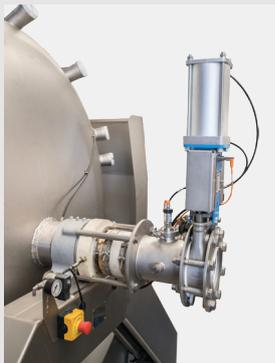
Entrée axiale avec vanne pneumatique
