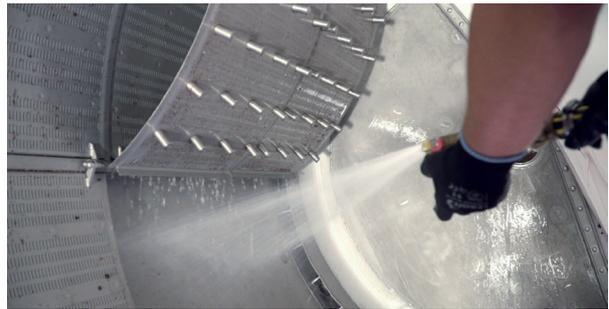
Grille de drainage Fast Press pivotante pour faciliter le lavage complet
