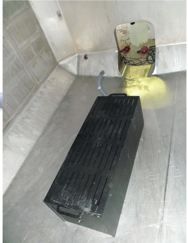
Ni vis, ni fixation, il est autoporteur grâce à ses blocs de béton intégrés et démontable, ce double caisson avec grille d'aspiration intérieure se relie à la vanne de sortie de cuve pour Ø 30-40-50 et plus. Compatible Thermo vinification - Equipé de poignée de portage. Nettoyage par trempage, aucun développement de bactérie, matériau inerte 100% incolmatable.
